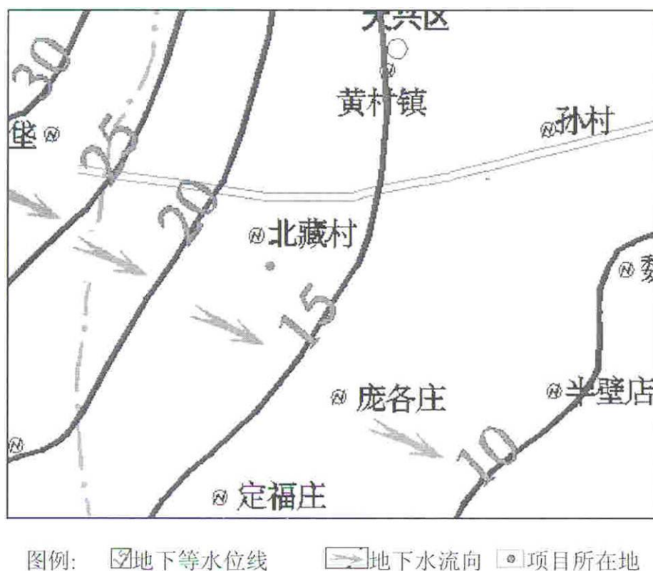
图 5-5 拟建项目所在区域潜水等水位线图
